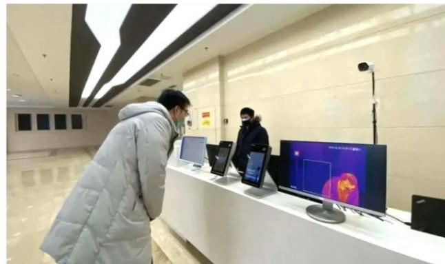
近日，川大智胜成功研发黑科技“防疫精准管控”系统，此套系统中的“三维人脸识别”技术，让不摘口罩就能刷脸成为现实，同时也可以分区管控进出乘坐电梯自动设置楼层，最终可以通过AI智能算法，对体温或行迹异常的人员的历史轨迹追溯及密切接触者发掘。
